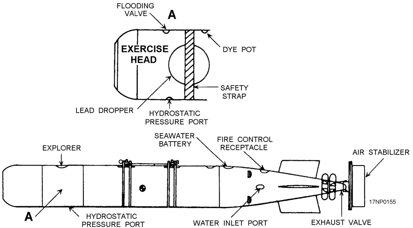
Figure 5-1.—Mk 46 torpedo.
